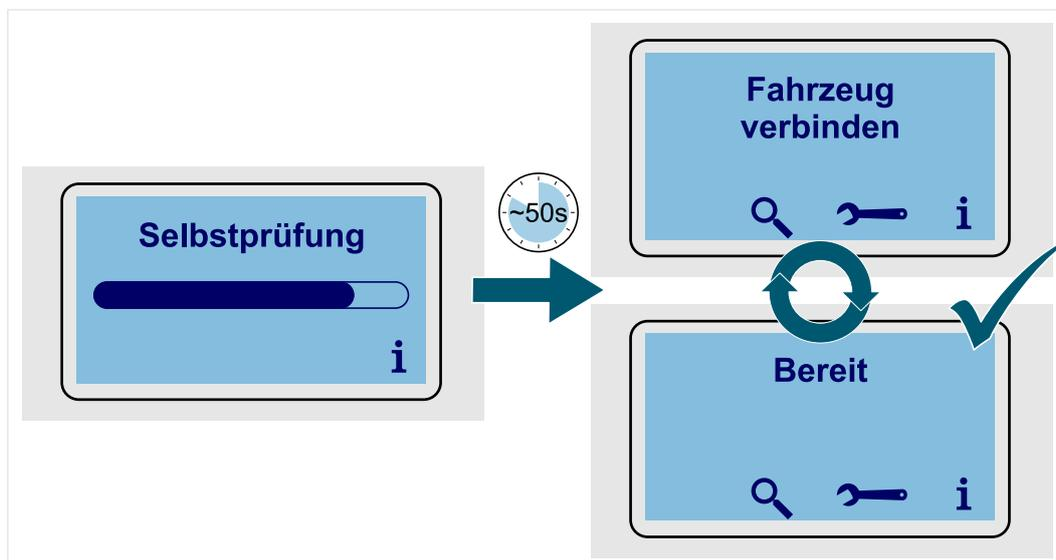
Während des Selbsttests sind bereits einzelne Funktionen über die Funktionstasten ansteuerbar (siehe Kapitel „Bedienung am LC-Display“).
