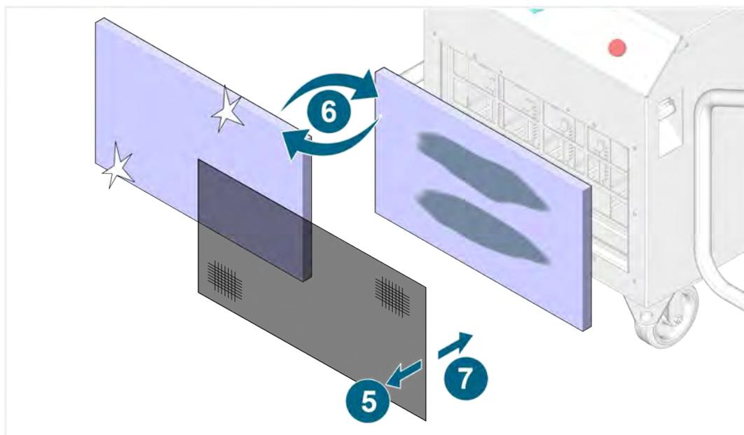
8. Befestigen Sie das Lüftungsgitter wieder mit den Schrauben.
