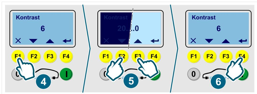
4. Verlassen Sie diese Einstellung durch Betätigen der Funktionstaste F1 (Abbrechen).
